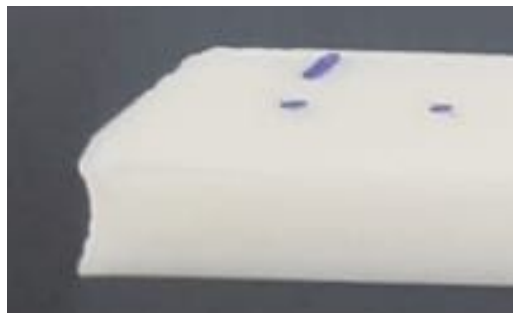
Figura 6. Borda de peça impressa a 130^\circ\text{C} demonstrando o efeito da lenta solidificação (foto de acervo próprio)
