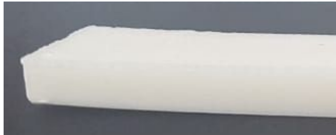
Figura 6. Borda de peça impressa a 130^\circ\text{C} demonstrando o efeito da lenta solidificação (foto de acervo próprio)
