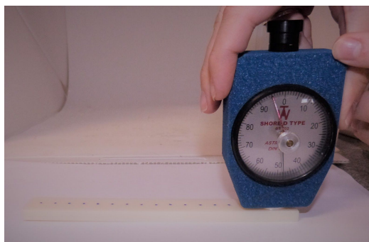
Figura 4. Medição com durômetro Shore D nos pontos marcados nas amostras (foto de acervo próprio)
